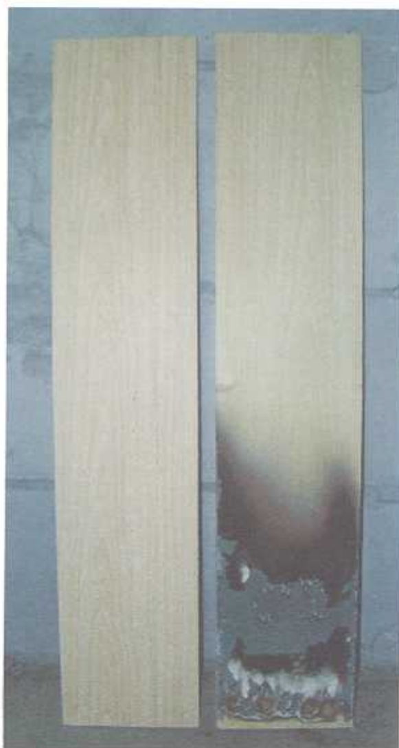
Рисунок 1 - Характерний вигляд зразка оздоблювальних панелей на основі ГКЛ (гіпсокартонний лист), торгової марки «Сгулат» (Кріплат), виробництва ООО «Кріплат-експорт» (г. Санкт-Петербург), до та після випробувань з визначення групи горючості згідно з 7 ДСТУ Б В.2.7-19-95 (ГОСТ 30244-94)
